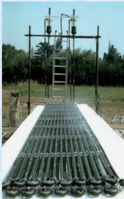
Dvouúrovňový trubicový fotobioreaktor tvořený smyčkou plastových trubic
