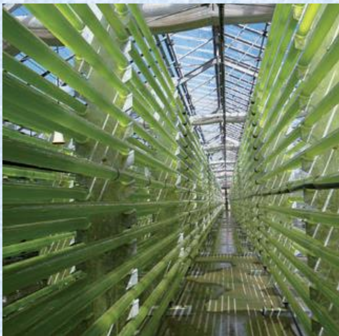
Fotobioreaktor tvořený souběžnými řadami vodorovných skleněných trubic umístěných ve skleníku s pomocným umělým osvětlením
